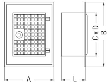
Reinigungstür mit Schiebestutzen und Lüftungsgitter
