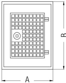
Reinigungstür mit Lüftungsgitter
